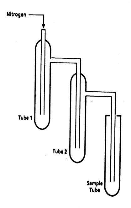
FIGURE 1. GASEOUS DIAZOMETHANE GENERATOR
